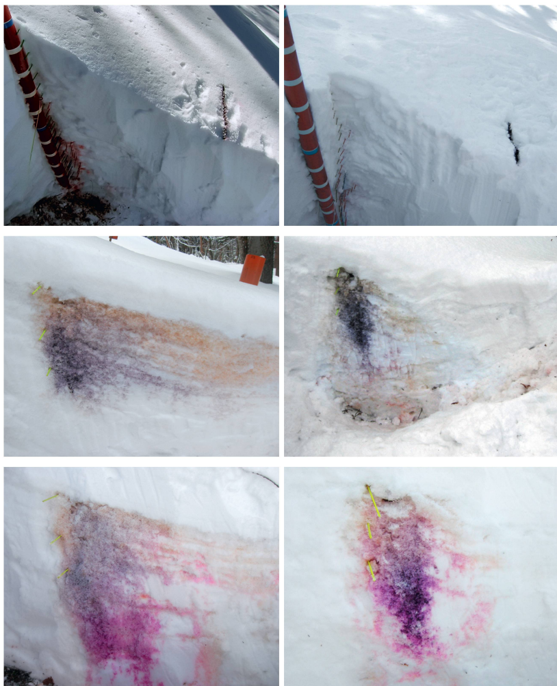
Abb 6 Niederschlags- und Schmelzwasserverlauf ausserhalb (links) und innerhalb der Zäunung (rechts) am Guggenauer Köpfl. Aufnahmezeitpunkte: 14.2.2006 (oben), 27.2.2006 (Mitte) und 15.3.2006 (unten).
