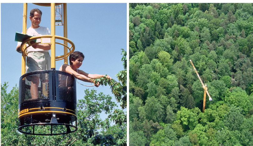
Abb 4 Das FACE-Forschungsprojekt in Hofstetten (SO). Manipulative Experimente mit adulten Waldbäumen stellen erhebliche Ansprüche an die Logistik. Links: Blattleitfähigkeitsmessungen von der Krangondel aus. Rechts: der Forschungskran aus der Luft.
