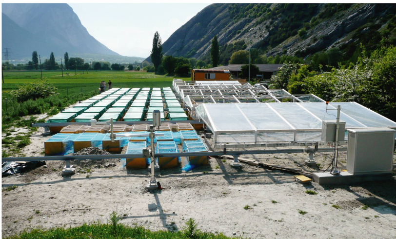
Abb 4 Verjüngungsexperiment bei Leuk (Wallis). Mittels Regendächern und Bodenheizung wird ein zukünftiges, trocken-heisses Klima simuliert und der Effekt auf die Baumverjüngung getestet. Foto: T. Wohlgemuth, WSL
