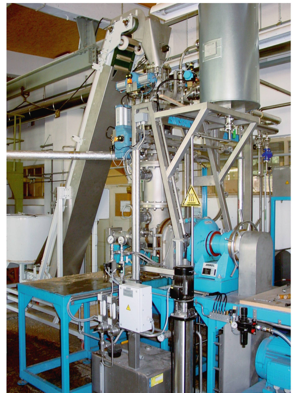
Abb 4 IHD-Laborerfaserungsanlage: Andritz-Refiner 12-1CPH. Kontinuierliche Betriebsweise im TMP- oder CTMP-Verfahren, mit Blowline-Beleimung und Stromrohr Trocknung. Foto: Lilie/IHD
