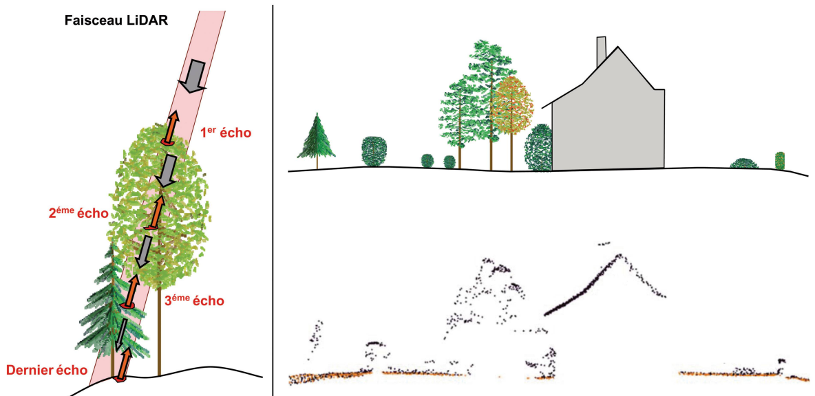
Fig. 2 Interaction des impulsions LiDAR avec les objets de surface. À gauche, enregistrement de plusieurs échos en milieu boisé. À droite, vue de profil à travers le nuage de points bruts dans un secteur mixte (bâtiment et végétation).
