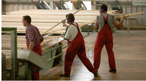
Abb 6 Sortierung von Schnittholz im Grosssägewerk.
