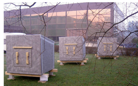
Versuchsbauten für die Testung des Klimaverlaufs.
