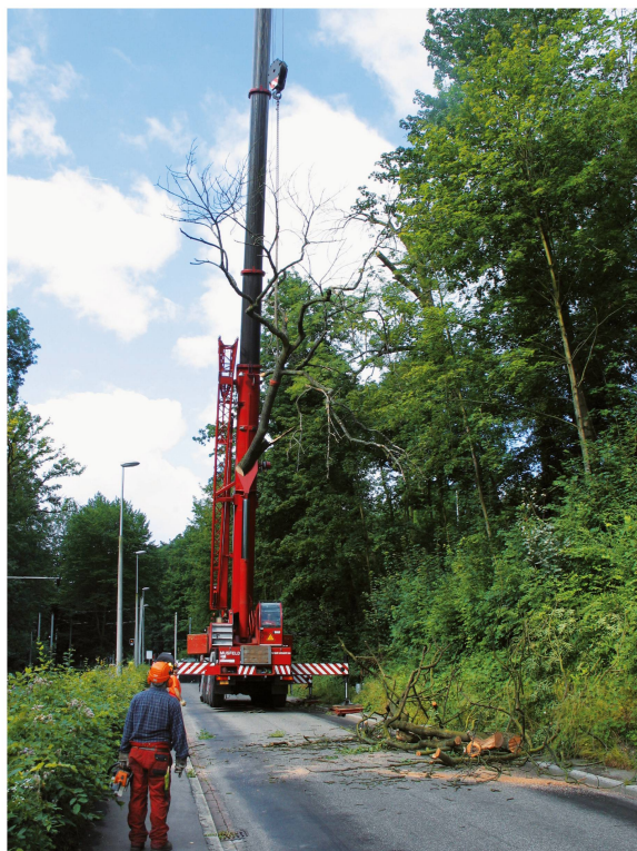
Abb 7 Waldpflege im Siedlungswald. Mit dem Kranwagen werden Kronenteile oder ganze Bäume aus dem Bestand gehoben.
