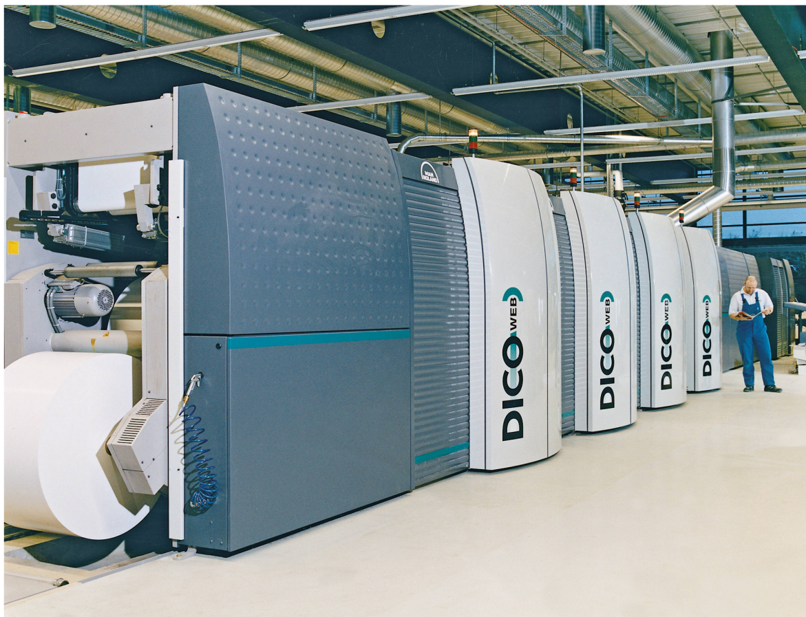
Abb. 2: Druckmaschine Dicoweb der Firma MAN Roland. Die Druckwalzen werden direkt ab Computer mit Hilfe eines Lasers innert weniger Minuten beschrieben («Computer-to-Press»-Verfahren). Nach dem Druck reinigen sich die Druckwalzen automatisch.
