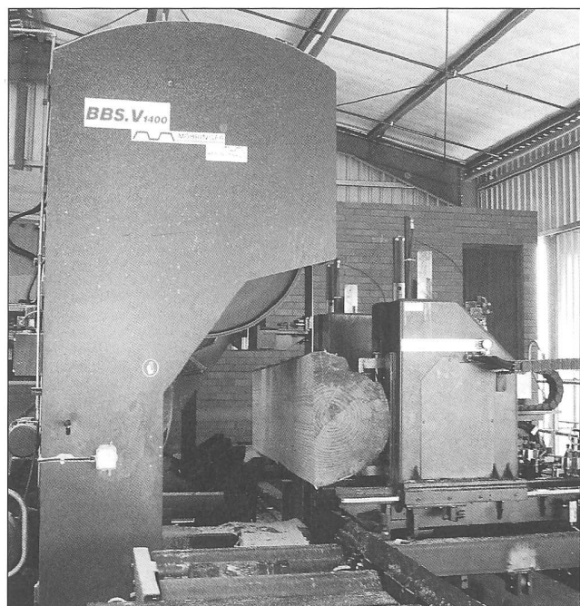
Abbildung 6: Blockbandsäge mit Stammscanner und automatischem Blockwagen (MÖHRINGER 2006).
