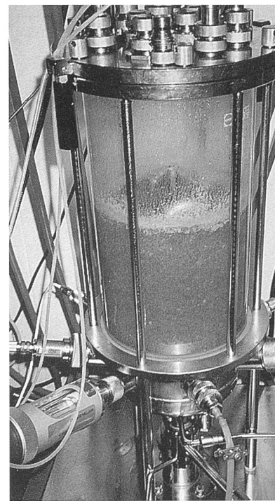
Abbildung 3: Anzucht von Inokulum im Submersfermenter.
