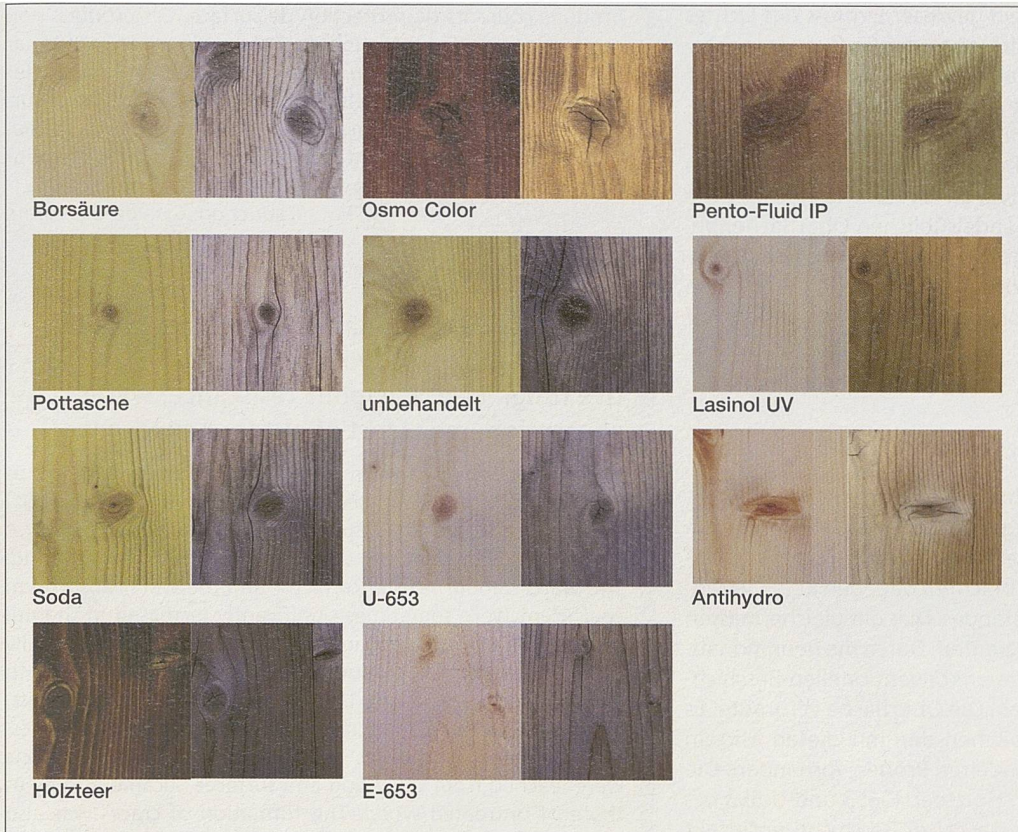
Abbildung 8: Oberflächen der Proben vor (links) und nach (rechts) der Freibewitterung (Aufnahme nach Klimatisierung im Normalklima).
