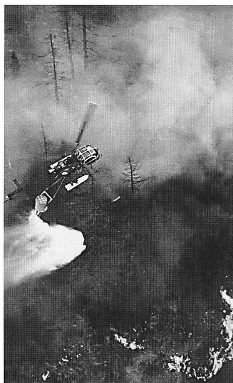
Figura 9: Primi prototipi di serbatoi antincendio per elicottero in uso negli anni Settanta (fonte: Archivio Sezione Forestale Cantonale, Bellinzona).
