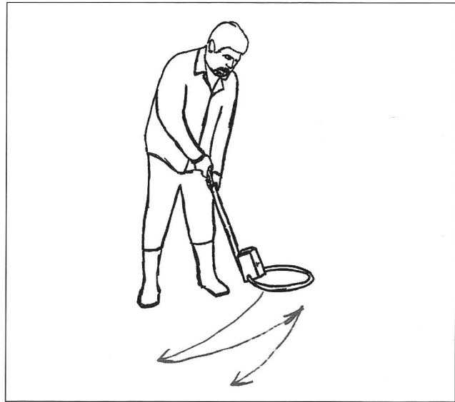
Abbildung 3: Mit einem Metalldetektor wird eine kleine Fläche systematisch abgesucht. Sobald ein elektrisch leitender Gegenstand in einen Kegel unterhalb dem Suchring gerät, ändert sich der Summton.
