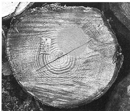
Figura 6: Esempio di cretto della fortuna. Si tratta di una fenditura radiale che si sviluppa nella zona centrale del fusto subito dopo l'abbattimento. Questo cretto viene chiamato «della fortuna» in quanto la sua presenza sta ad indicare che la coesione radiale del legno è sufficientemente buona per contrapporsi alla formazione di cipollature.
