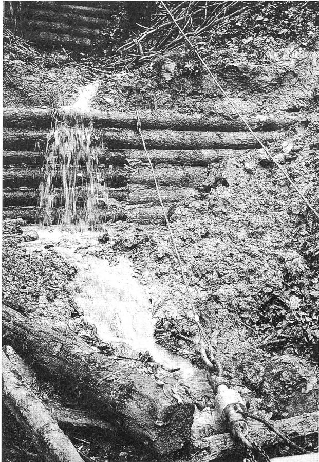
Abbildung 3: Biegebruchversuch an einer einwandigen Holzsperr (Dia: Martin Frei).
