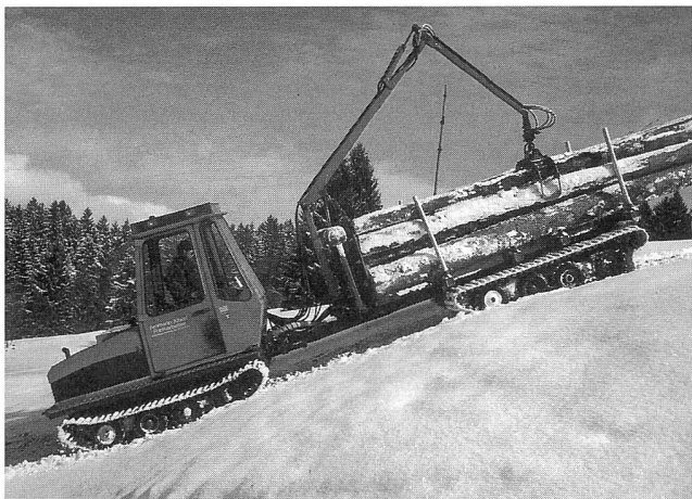
Abbildung 1: Holztransport mit dem Raupen-Forwarder 30.60.
