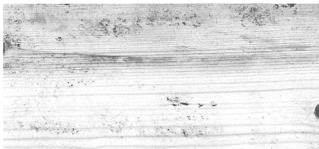
Abbildung 6: Bläuepilze und Rotstreifigkeit an in einem Stapel ohne Zwischenlagen eingelagertem Holz.
