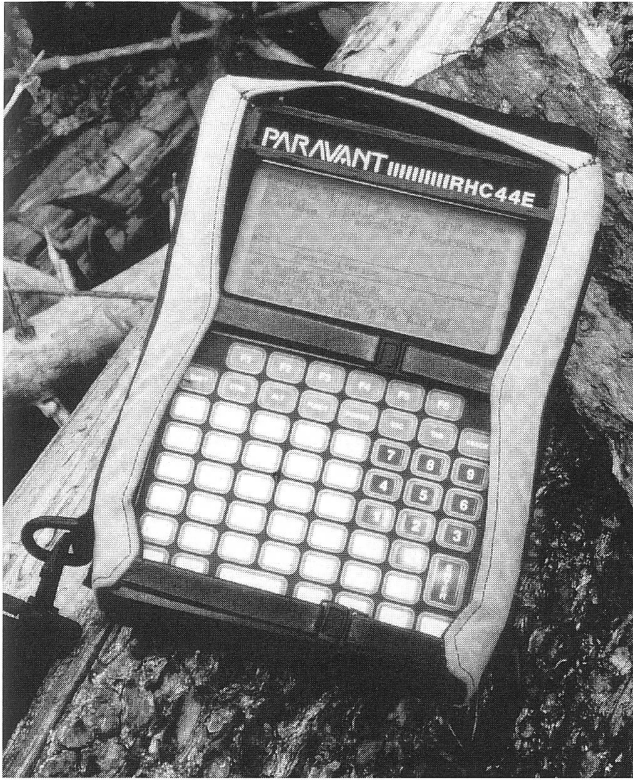
Abbildung 1: Feldcomputer Paravant in der Schutztasche. Beim Transport wird die Schutzlasche geschlossen, damit der Bildschirm nicht verkratzt werden kann.
