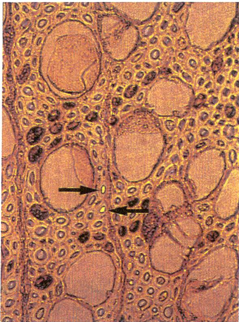
Abbildung 6. Buche Nr. 5, Spritzkern quer, blasse gelbe Füllungen der Tracheiden (Pfeil). Vergrößerung etwa 140fach.
