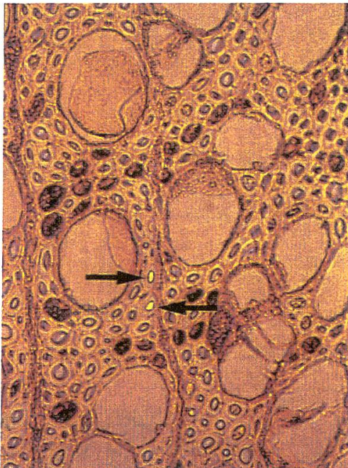
Abbildung 6. Buche Nr. 5, Spritzkern quer, blassgelbe Füllungen der Tracheiden (Pfeil). Vergrößerung etwa 140fach.
