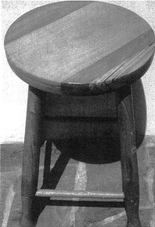
Abbildung 5. Holzhocker aus ausländischer Produktion mit deutlichem Anteil an verfärbtem (ersticktem und verstocktem), aber noch nagelfestem Holz.
