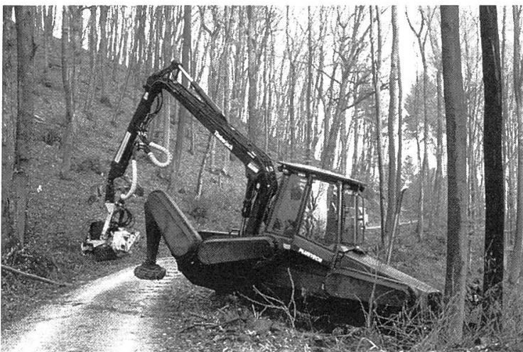
Abbildung 5. Schreitharvester PLUSTECH, Prototyp. Der Natur abgeschautes Schreitprinzip ermöglicht sehr hohe Mobilität im Gelände, was bei schwierigen, inhomogenen Verhältnissen von Vorteil ist. Prototyp, noch nicht für den Einsatz im steilen Gelände konzipiert. (Foto WSL)
