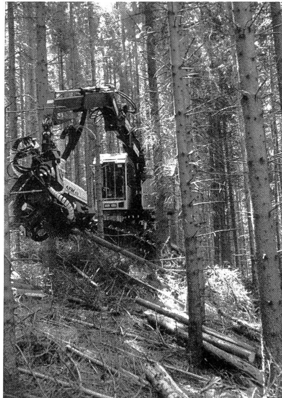
Abbildung 4. Raupenharvester TIMBCO 445C. Hohes Eigengewicht der Maschinen (25 bis 30 t) ermöglicht grosse Kranreichweiten bei gleichzeitig grossen Hubkräften ( >10\text{kN} bei 15 m). Nutzbare Kranreichweite bei ungenügenden Sicht- und Platzverhältnissen in den Beständen (z. B. bei Erstdurchforstungen) eingeschränkt. (Foto WSL)
