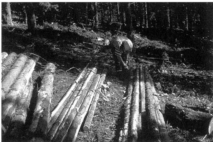
Abbildung 6. Vorkonzentration des Holzes an der Seillinie infolge der Harvesteraufarbeitung. Die Vorkonzentration führt zu einer beträchtlichen Leistungssteigerung beim Rücken. (Foto Forstverwaltung Mayr-Melnhof-Saurau).
