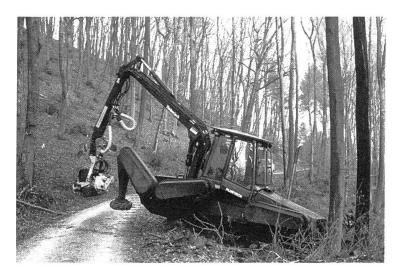
Abbildung 5. Schreitharvester PLUSTECH, Prototyp. Der Natur abgeschautes Schreitprinzip ermöglicht sehr hohe Mobilität im Gelände, was bei schwierigen, inhomogenen Verhältnissen von Vorteil ist. Prototyp, noch nicht für den Einsatz im steilen Gelände konzipiert. (Foto WSL)
