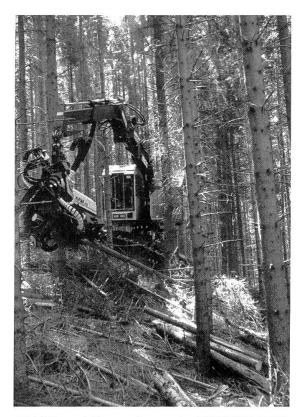
Abbildung 4. Raupenharvester TIMBCO 445C. Hohes Eigengewicht der Maschinen (25 bis 30 t) ermöglicht grosse Kranreichweiten bei gleichzeitig grossen Hubkräften (>10kN bei 15 m). Nutzbare Kranreichweite bei ungenügenden Sicht- und Platzverhältnissen in den Beständen (z. B. bei Erstdurchforstungen) eingeschränkt. (Foto WSL)
