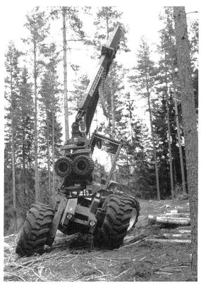
Abbildung 3. Spezialisierter Radharvester für schwieriges Gelände, SKOGSJAN 487 XL. Beim Einsatz von konventionellen Radmaschinen unter extremen Geländeverhältnissen ist zu bedenken, dass nicht alles, was in Einzelfällen technisch machbar ist, auch wirtschaftlich und unter dem Aspekt der Arbeitssicherheit sinnvoll sein muss, insbesondere, wenn solche Einsätze oft erfolgen sollen. (Foto WSL)
