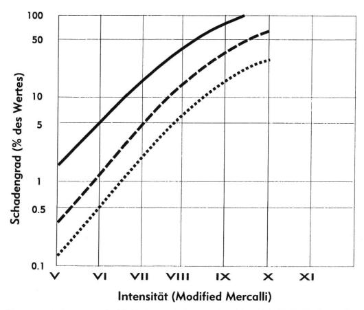
Abbildung 6. Schadenenempfindlichkeit von Gebäuden in Abhängigkeit der Erdbebenintensität (nach Schraft et al., 1993). Der mittlere Schadengrad ist definiert als Schadensumme in Prozenten des Gebäudewertes.
