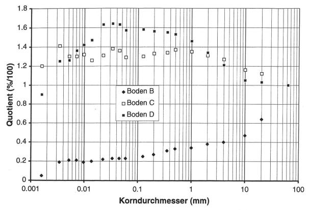
Abbildung 2. Vergleich der Korngrössen der vier Bodenproben (A, B, C, D) dargestellt als Quotienten der einzelnen Korndurchmesser, wobei die Probe A als Referenz dient (A/A, B/A, C/A, D/A).
