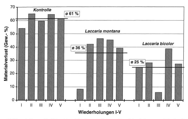
Abbildung 5. Unterschiedlicher Materialverlust von Körpern künstlicher Substratgemische durch Abbröckeln nach 24 h Wassersättigung von unbehandelten Kontrollen (ø 61% Gewichtsverlust des Ausgangskörpers) und beimpften Proben mit den Ektomykorrhizapilzen Laccaria montana (ø 36% Verlust) und Laccaria bicolor (ø 25% Verlust).
