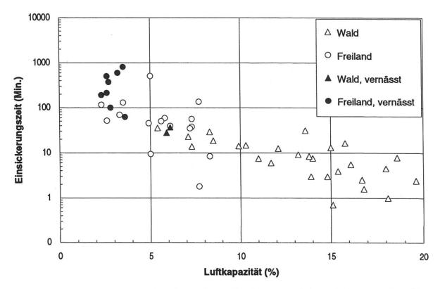
Abbildung 1. Einsickerungszeit in Minuten für 1 Liter Wasser auf einer Fläche von 100 cm<sup>2</sup> in Abhängigkeit der Luftkapazität (Grobporenvolumen) des Oberbodens. Daten aus *Burger* (1922, 1927 und 1937).
