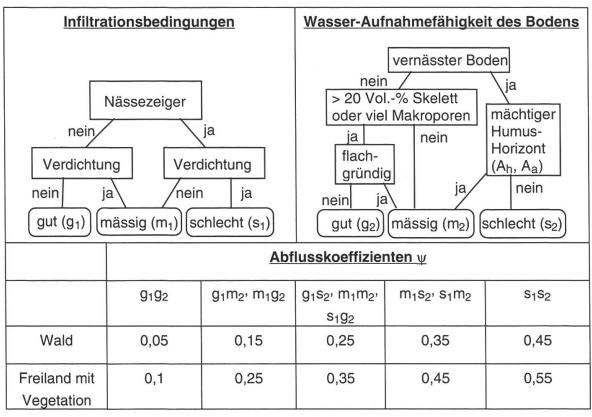
Abbildung 2. Abflusskoeffizienten  $\psi$  für den Einsatz in Hochwasser-Bemessungsansätzen. Sie werden für Wald und Freiland in Abhängigkeit von den Infiltrationsbedingungen an der Bodenoberfläche und von der Wasser-Aufnahmefähigkeit des Bodens festgelegt.
