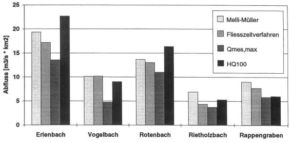
Abbildung 3. Vergleich der Hochwasser-Bemessungsansätze Melli-Müller und Fliesszeitverfahren mit den höchsten gemessenen Abflüssen (Qmes, max) und aus langjährigen Messreihen abgeleiteten 100jährlichen Hochwassermengen (HQ100).
