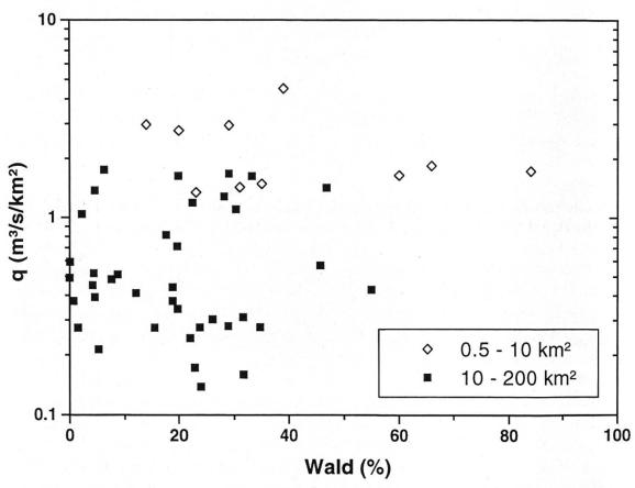
Abbildung 1. Das mittlere jährliche Hochwasser in Abhängigkeit vom Bewaldungsprozent für zwei Klassen von Einzugsgebietsgrössen.
