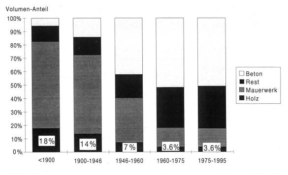
Abbildung 5. Zusammensetzung der Baumaterialien im Gebäudepark des Kantons Aargau. (Daten aus Wüest et al., 1995).
