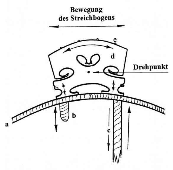
Abbildung 2. Bewegungsabläufe um den Steg (a - Deckplatte, b - Bassbalken, c - Stimmstock, d - Steg).
