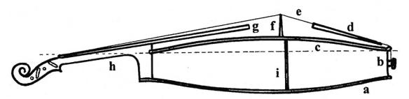
Abbildung 1. Teile einer Violine (a - Bodenplatte, b - Zargen = Seitenwände, c - Deckplatte, d - Saitenhalter, e - Saite, f - Steg, g - Griffbrett, h - Hals, i - Stimmstock).
