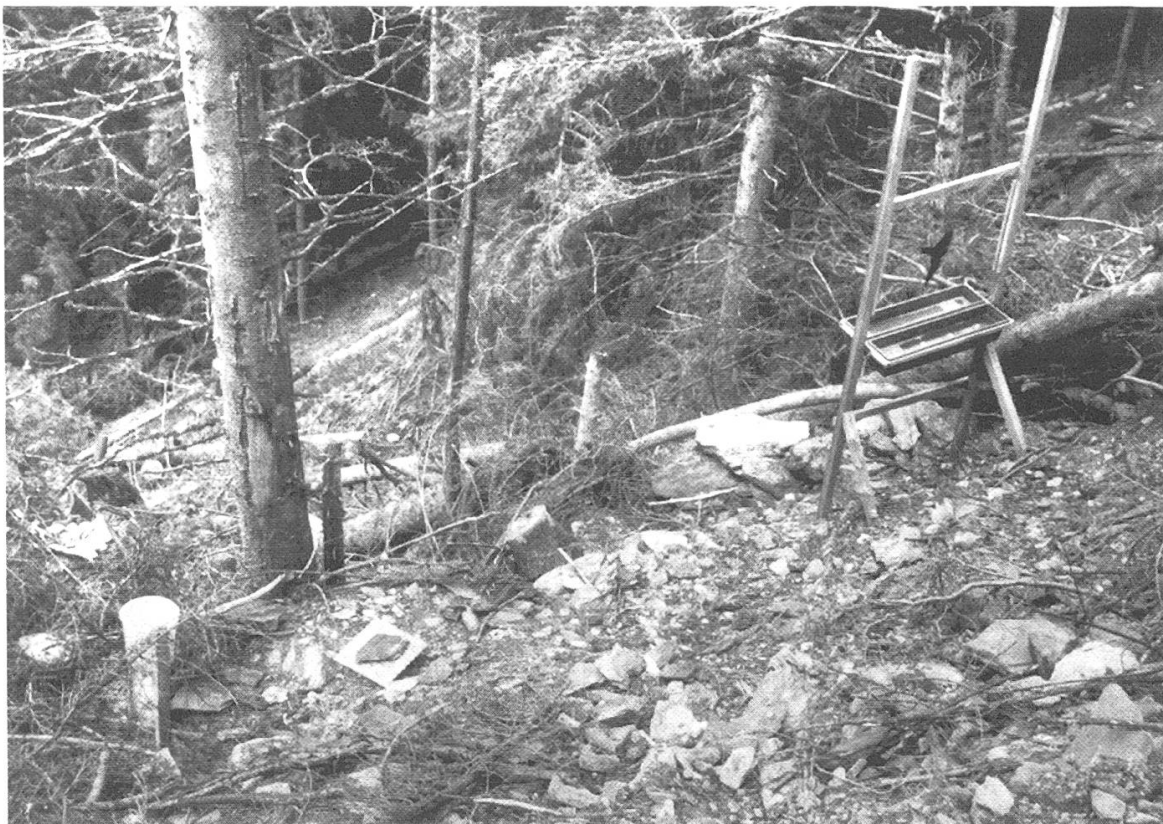
Abbildung 1. Insektenfallen-Set in Pfäfers: Gelfalle (Eimer, unten links), Bodentrichterfalle (mit Abdeckung, Mitte links), Fensterfalle (oben rechts).
