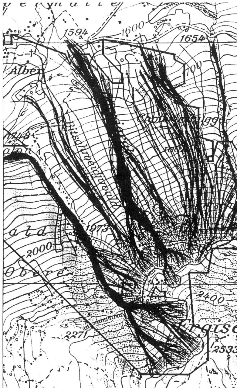
Abbildung 3. Beispiel Obermatte Ergisch (Vergrößerung der Landeskarte 1:25 000): Vergleich der Modellierung des Sturz-Prozessraumes nach dem Pauschalgefällsansatz und der dreidimensionalen Modellierung der Trajektorien mit dem Berechnungsprogramm Zinggeler + Geotest, unter Einbezug der realen Parameter Waldbestand, Bodenrauigkeit und Dämpfung des Untergrundes. Die Modellierung des Pauschalgefälles zeigt im Transitbereich keine räumliche Differenzierung bezüglich des Reliefs, d.h. der potentielle Sturzraum bedeckt den ganzen Hangbereich. Das Trajektorienmodell hingegen zeigt die Konzentration der Sturzbahnen in den Gräben. Im Ablagerungsbereich dominiert allgemein die grössere Ausbreitung des Prozessraumes durch das Pauschalgefällsmodell (dicke ausgezogene Linie). Die grosse Ausbreitung des Pauschalgefälls-Prozessraumes im Nordwesten ist dadurch zu erklären, dass grobblockige Sturzablagerungen im mittleren Hangbereich, die eine weitere Ausbreitung verhindern, im Pauschalgefällsmodell nicht berücksichtigt werden. Das Divergieren der seitlichen Sturzraumbegrenzung im Westen durch das Pauschalgefällsmodell ist darauf zurückzuführen, dass seitliche Abweichungen von der Fallinie mitberücksichtigt werden, während das Trajektorienmodell direkt auf die aktuelle Exposition einer Rasterzelle reagiert. Bei ungünstigen Geländebedingungen (konvexe Hangform) kann bei der Pauschalgefällsmodellierung eine zu starke seitliche Ausbreitung erfolgen.
