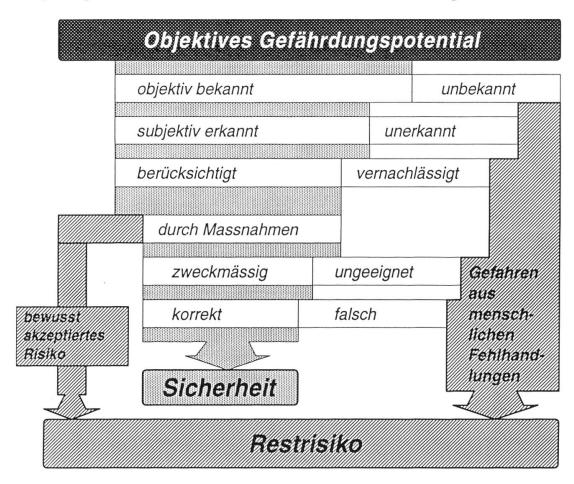
Abbildung 3. Gefährdungspotential, Sicherheit und Restrisiko (nach Schneider, 1994). Eine Analyse der Schadenfälle im Bauwesen hat ergeben, dass 75 % der Schadenfälle ihren Ausgangspunkt bei menschlichen Fehlhandlungen haben (rechte Seite des Schemas). Zukünftige Sicherheitskonzepte müssen das akzeptierte Restrisiko und mögliche menschliche Fehlhandlungen von Anfang an mitberücksichtigen.
