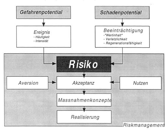
Abbildung 4. Risikoanalyse und Risikomanagement als methodische Ansätze. Die Risikoanalyse umfasst die Gefahrenanalyse und die Schadenpotentialanalyse. Sie liefert objektive Aussagen über das Risiko. Risikomanagement beinhaltet eine Bewertung von Risiko, Nutzen, Aversion und führt zur Entscheidung, welches Restrisiko akzeptiert wird und welche Massnahmenkonzepte zur Reduktion des vorhandenen Risikos angewandt werden sollen.
