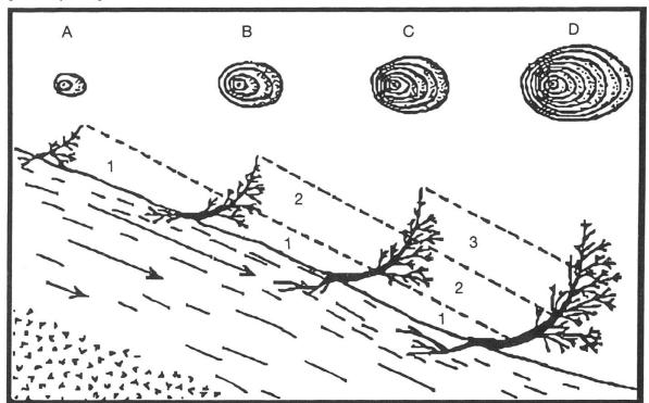
Abbildung 7. Hypothetische Abfolge des Wachstums eines Nadelbaumes auf langsam und kontinuierlich bewegtem Untergrund (nach *Parizek* und *Woodruff* 1957, abgeändert). Die Pfeile deuten die Hangbewegung an. 1–3 zeigen den jährlichen Höhenzuwachs. A–D entsprechen vier Stadien desselben Baumes nach jeweils zwei Jahren. Punktiert ist das Druckholz.
