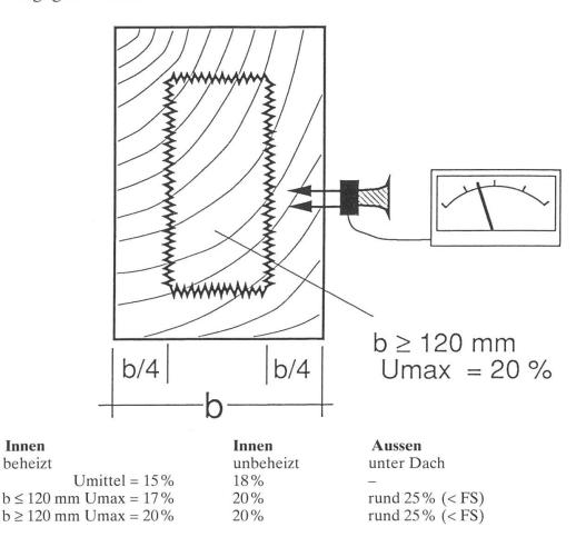
Abbildung 1. Richtwerte zur Einbaufeuchte von Konstruktionsholz (u = % Holzfeuchte).
