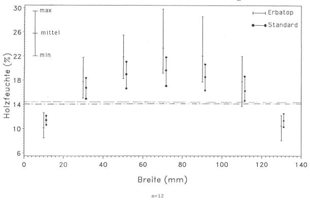
Abbildung 2. Holzfeuchteverteilung über den Kantholzquerschnitt nach Frischluft-/Ablufttrocknung unter Standardbedingungen bzw. unter Einsatz des Zusatzmittels Erbatop. Mittelwerte aus je 12 Kanthölzern.
