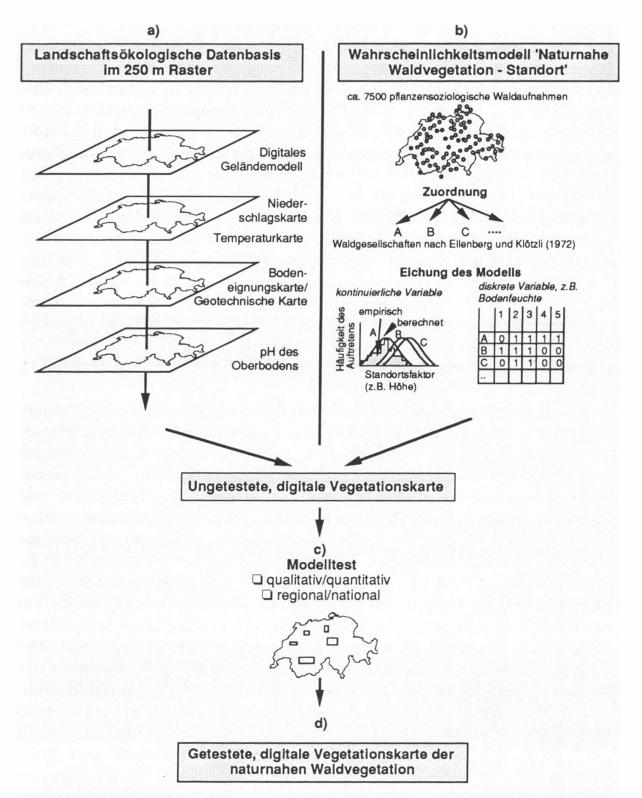
Abbildung 1. Die Herstellung digitaler Vegetationskarten (d) mittels Simulationsmodell (b), landschaftsökologischer Datenbasis (a) und GIS-Technologie.
