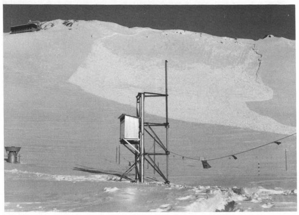
Abbildung 6. Beobachterstation Weissfluhjoch mit horizontalem Messfeld und Lawinenabgang am benachbarten Hang.
