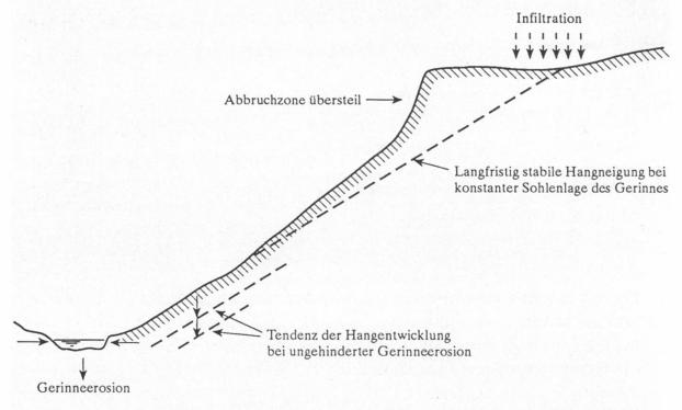
Abbildung 1. Profil durch ein Gerinne mit einem seitlichen Rutschhang in nichtbindigem Lockermaterial.
