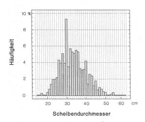
Abbildung 7. Häufigkeitsverteilung (%) der Scheibendurchmesser im untersuchten Probenkollektiv (N = 944).
