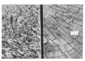
Abbildung 18. Querschnittsflächen von Fichtenstämmen, abgetrennt mit einem Prozessor (links) bzw. mit einer Motorsäge (rechts). Massstab = 1 cm.
