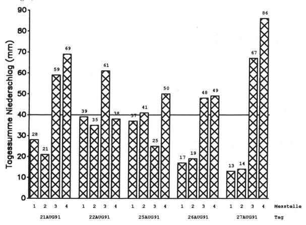
Abbildung 5. Tägliche Beregnungsmengen an vier Messstellen auf einem Langholzpolter. Es zeigen sich sowohl Unterschiede zwischen verschiedenen Polterbereichen als auch Tagesschwankungen. Der empfohlene Richtwert von 40 mm/Tag ist als Referenzlinie eingezeichnet.
