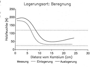
Die wiederholte Probenahme beim Lagerungsbeginn und bei der Auslagerung ermöglicht die einzelstammweise Erfassung von Veränderungen während der Lagerung. Der Einfluss der Lagerungsmethode auf die Holzfeuchte im Stammquerschnitt ist besonders im Splint gut erkennbar (Abbildung 1). Auch ein Vergleich der mittleren Holzfeuchte im Splint aller Probestämme zeigt die gut konservierende Wirkung einer Beregnung (Abbildung 2).
