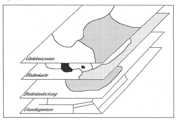
Abbildung 3. Das Ebenenprinzip eines vektororientierten GIS.
