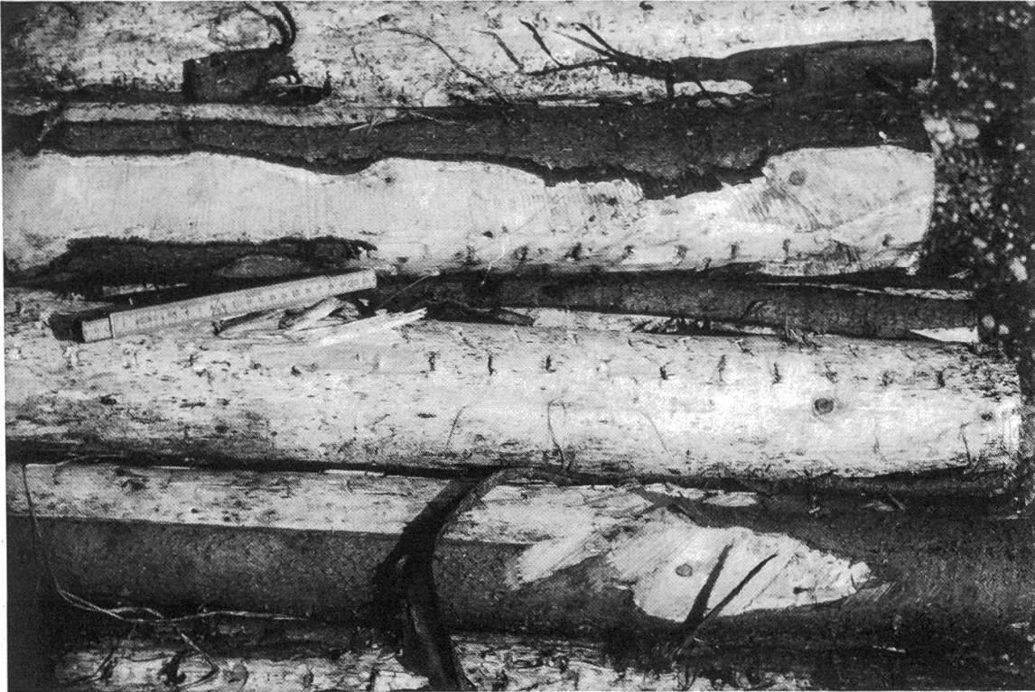
Abbildung 9. Teilentrindung durch Entastungsmesser.
