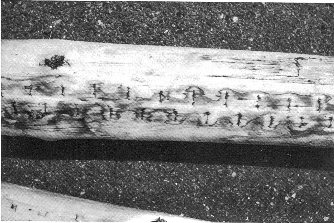
Abbildung 5. Stachelwalzeneindrücke im Holz.
