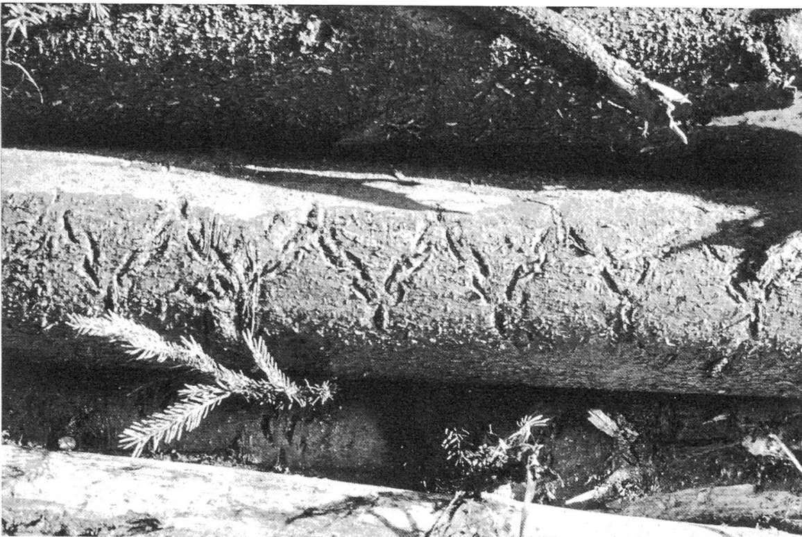
Abbildung 6. Ketteneindrücke auf der Rinde.
