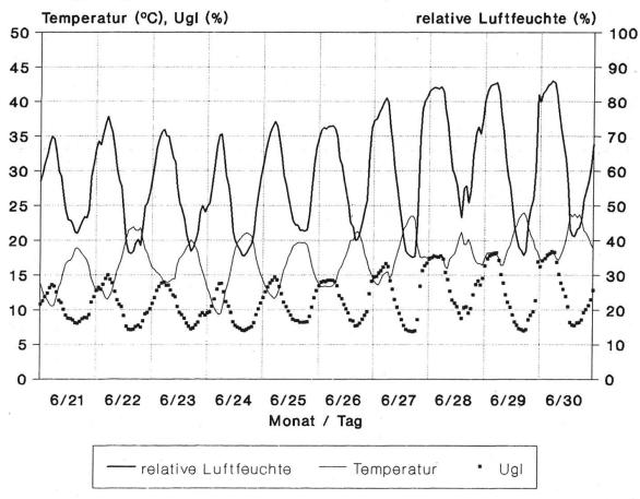
Abbildung 1. Ausschnitt des Klimaverlaufs am Versuchsort im Juni 1988. Stundenmittelwerte für Temperatur, relative Luftfeuchte und Holzausgleichsfeuchte (ugl). ugl-Berechnung nach Zuritz et. al. (1979), zitiert in Avramidis (1989).
