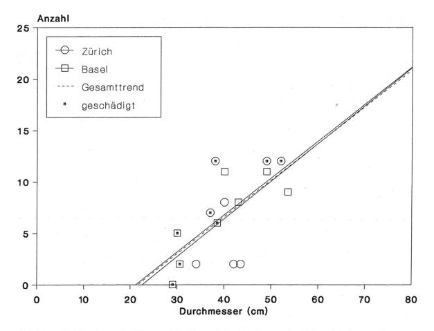
Abbildung 8. Zunahme der Rissanzahl während der Trocknung in Abhängigkeit vom Stammdurchmesser (Gesamttrend), gruppiert nach Standort (Trendlinien für Zürich und Basel) und Gesundheitszustand (ohne Trendlinien); die Einzelwerte beziehen sich jeweils auf ein komplettes Bretterpaket.
