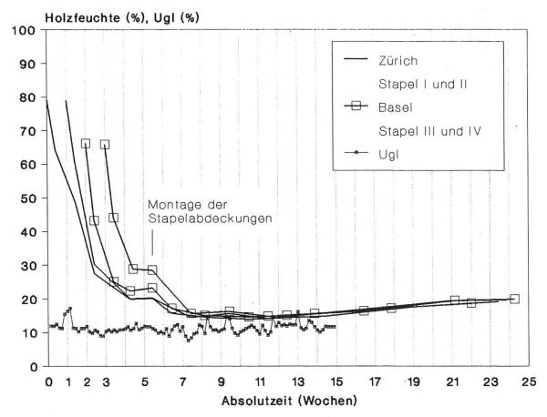
Abbildung 2. Holzfeuchteverlauf der einzelnen Stapel (25 mm dicke Bretter). Mittelwerte aus je vier Bäumen (zwei gesunde und zwei geschädigte Exemplare vom gleichen Standort). «Absolutzeit» bedeutet termingleiche Eintragung; die Stapel I bis IV wurden, beginnend mit 31. Mai 1988, in wöchentlichem Abstand errichtet. Zum Vergleich ist die aus den Tagesmittelwerten für relative Luftfeuchte und Temperatur berechnete Holzausgleichsfeuchte ( $u_{\rm el}$ ) eingetragen.
