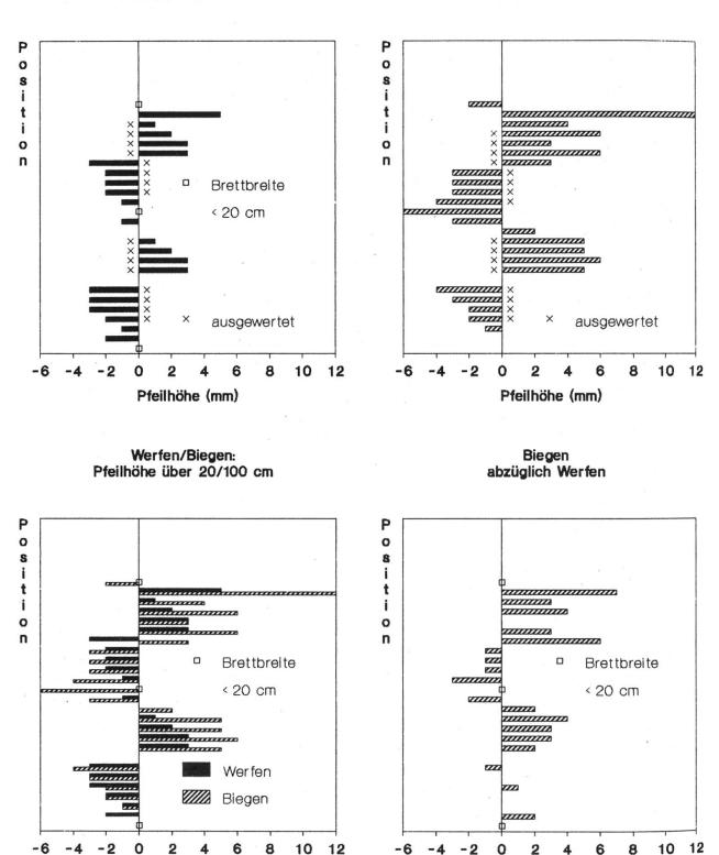
Abbildung 7. Werfen und Biegen der Einzelbretter in der Stapelposition (Anordnung wie bei Blockware): Stapel I, halbseitig, zwei Bretterpakete übereinander. Für die Mittelwertbildung pro Stamm wurden je 2 x 4 marknahe Bretter ausgewertet, Kernbretter ohne Werfen wurden nicht berücksichtigt.
