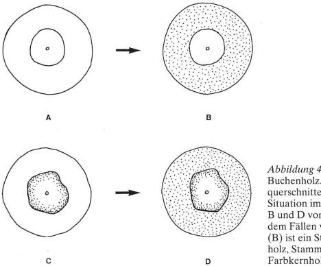
Abbildung 4. Die Verthyllung von Buchenholz. A bis D sind Stammquerschnitte, A und C geben die Situation im stehenden Baum, B und D von Bäumen, welche nach dem Fällen verthyllt sind. Stamm A (B) ist ein Stamm mit hellem Kernholz, Stamm C (D) hat fakultatives Farbkernholz (Rotkern).
