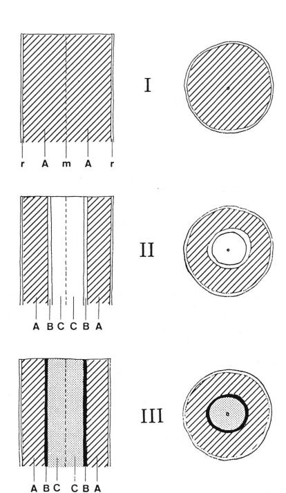
Abbildung 6. Schematische Längs- (links) und Querschnitte (rechts) von Buchenstämmen. Die drei Typen stehen für die wichtigsten Ausgangszustände, in welchen Buchenstämme sich befinden können. A = Holzfeuchtegehalt über rund 60%, B = Übergangszone, C = Holzfeuchtegehalt unter rund 60%, m = Mark, r = Rinde. Typus III gibt einen Stamm mit fakultativem Farbkernholz (Rotkern) wieder.
