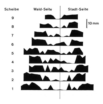
Abbildung 2. Durchlässigkeit des Buchenholzes für Wasser, wobei der Zusammenhang mit Rotkerngrenzen, das heisst Verthyllungsgrad und Durchlässigkeit, deutlich wird (1 mm vertikal = 100 cc Wasser/Minute).
