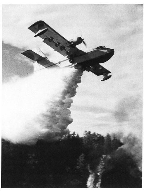
Abbildung 4. Wasserbomber beim Löscheinsatz. Bei grösseren Waldbränden muss die Bekämpfung aus der Luft erfolgen. Die Firma Canadair in Montreal (Kanada) stellt dafür ein spezielles Löschflugzeug her, den Wasserbomber CL-215 (Foto: Canadair Inc., Montreal, Kanada).
