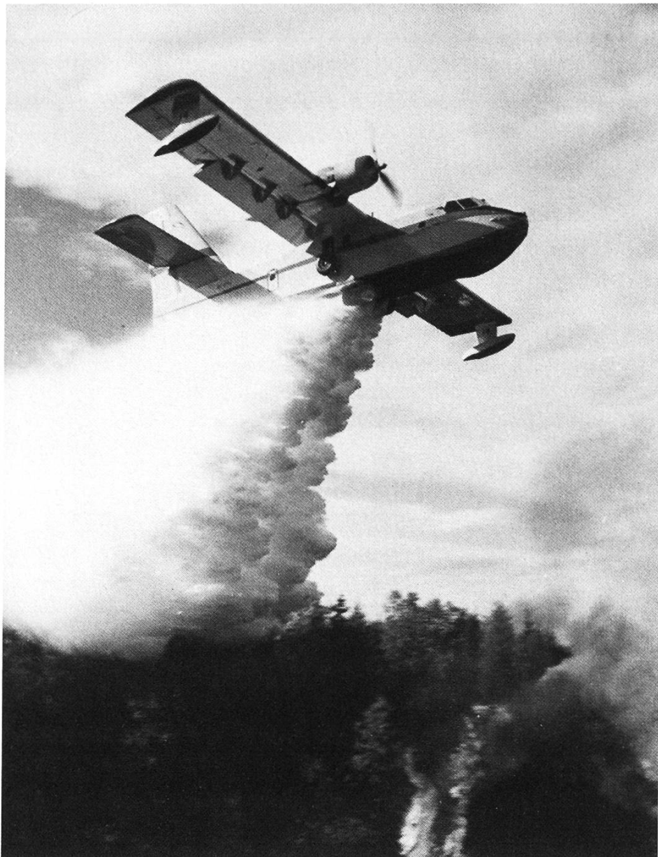
Abbildung 4. Wasserbomber beim Löscheinsatz. Bei grösseren Waldbränden muss die Bekämpfung aus der Luft erfolgen. Die Firma Canadair in Montreal (Kanada) stellt dafür ein spezielles Löschflugzeug her, den Wasserbomber CL-215 (Foto: Canadair Inc., Montreal, Kanada).
