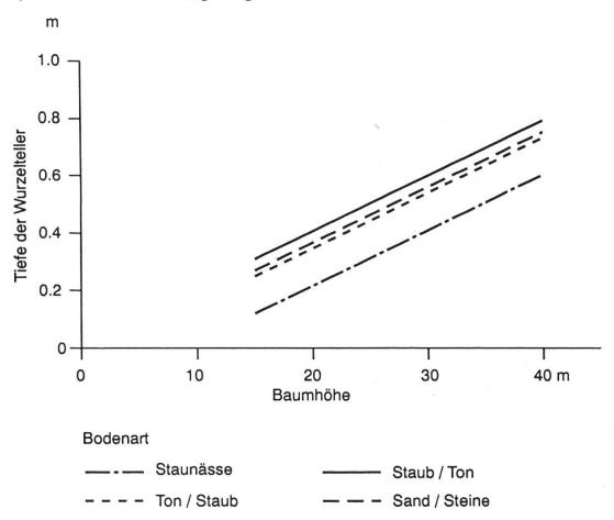
Abbildung 5. Tiefe der ausgehobenen Wurzelteller in Abhängigkeit von Baumhöhe und Bodenart (Fichte).
