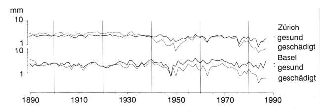
Abbildung 3. Radialzuwachs von 1890 bis 1987 für Schadklassen-Mittel Zürich/gesund, Zürich/geschädigt, Basel/gesund und Basel/geschädigt; Ordinaten logarithmisch.
