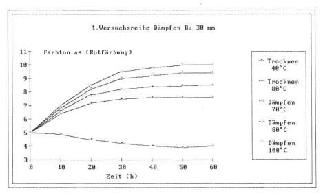
Abbildung 5. Einflüsse von Temperatur und Zeit auf die Rotfärbung beim Trocknen und Dämpfen von Buchenschnittholz.
