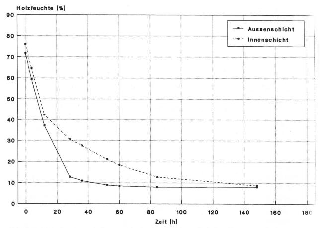
Abbildung 1. Trocknungsverhalten von Buchenholz bei der technischen Trocknung.
