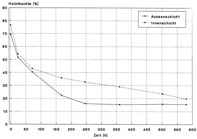
Abbildung 2. Trocknungsverhalten von Buchenholz bei der Freilufttrocknung.
