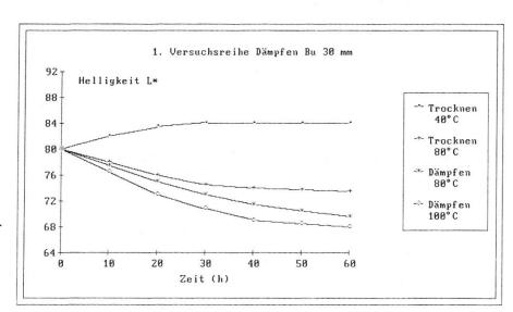
Abbildung 7. Einflüsse von Temperatur und Zeit auf die Helligkeit beim Trocknen und Dämpfen von Buchenschnittholz.
