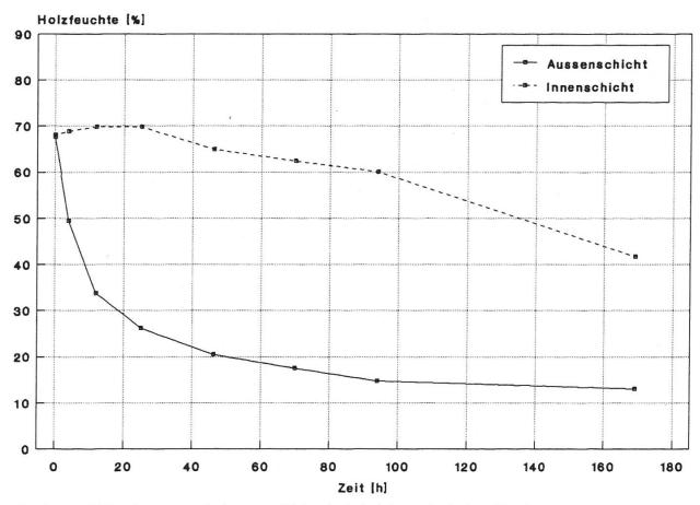
Abbildung 3. Trocknungsverhalten von Eichenholz bei der technischen Trocknung.
