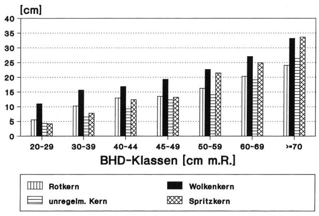
Abbildung 9. Mittlerer Kerndurchmesser nach BHD-Klassen, Schnittfläche 2.
