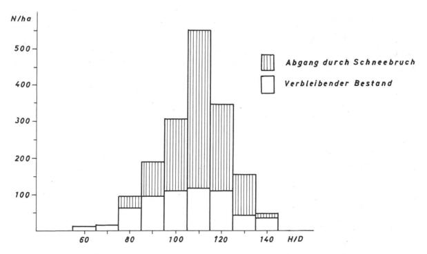
Abbildung 1. Durch Schneebruch wird die Gauss'sche Verteilungskurve abgeflacht, jedoch nicht seitlich eingeengt.
