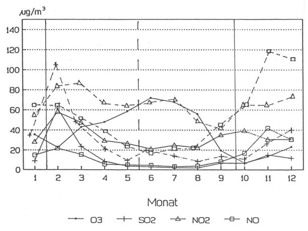
Abbildung 1. Vergleich der Monatsmittelwerte 1986 an O<sub>3</sub>, SO<sub>2</sub>, NO<sub>2</sub> und NO von Birmensdorf (Nullprobe, ausgezogene Linien) und Schwamendingen (gestrichelte Linien).
