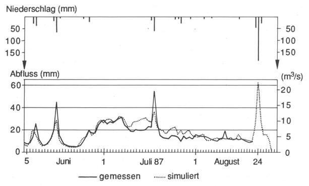
Abbildung 5. Gemessener und simulierter Tagesabfluss für das Testgebiet der Witenwasserenreuss aufgrund des Tagesniederschlages vom 22. Juni bis 25. August 1987. Der Limmnigraph an der Witenwasserenreuss wurde während des Ereignisses vom August 1987 zerstört.
